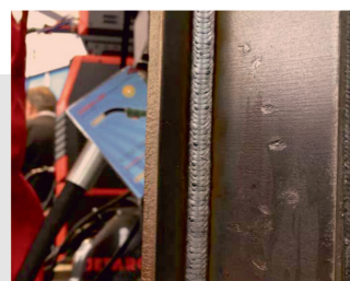
Вертикальная сварка снизу вверх без колебаний
