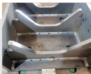
Тяжелые металлоконструкции Высокоскоростная сварка несколькими горелками
