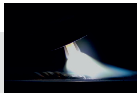
TIG сварка с треугольной формой волны
